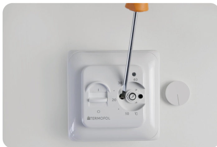
Způsob demontáže předního panelu
