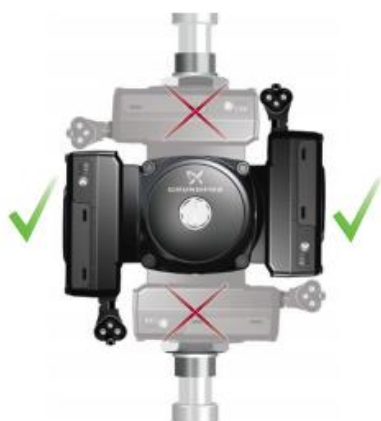
Obrázek 8 Povolené polohy ovládací skříňky v prostředí bez kondenzace
