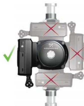
Obrázek 9 Povolené polohy ovládací skříňky v prostředí s kondenzací
